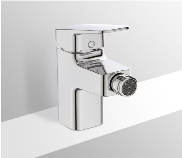
Miscelatore monocomando per bidet con bocca di erogazione fissa getto orientabile, aeratore M24x1 limitato a 5 l/min, asta di comando dello scarico, piletta da 1-1/4". Cartuccia da 38 mm con limitatore della temperatura. Tubi flessibili. Fissaggio Easy Fix.
