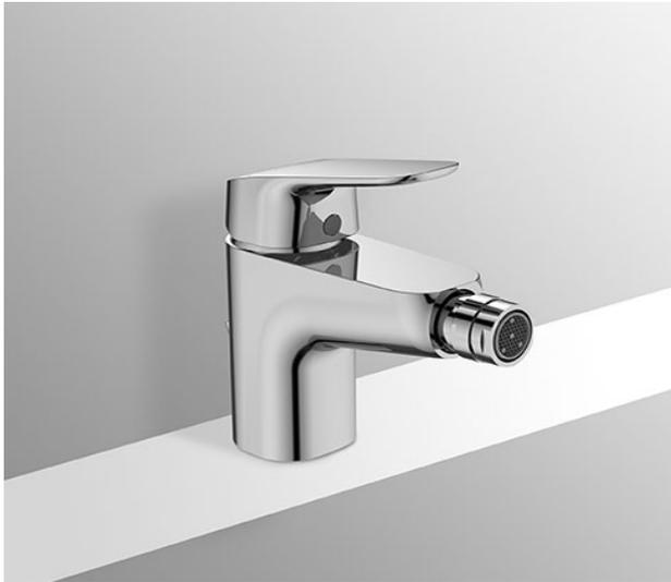
con bocca di erogazione fissa, rompigetto orientabile. Dotato di cartuccia FirmaFlow® da 38 mm con sistema EKO. Sistema di fissaggio EasyFix. Tubi flessibili con attacco G3/8". Con asta di comando e scarico pileta da 1-1/4".
